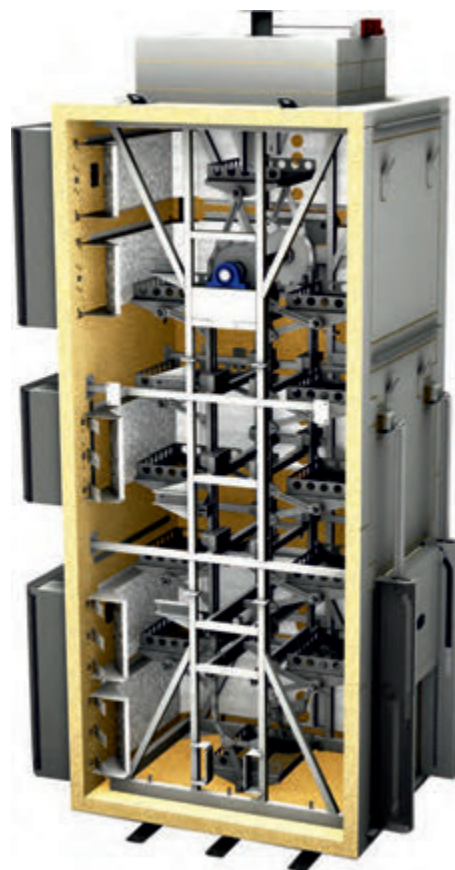
S 4200/35 Schéma uspořádání dopravníku (řez)
