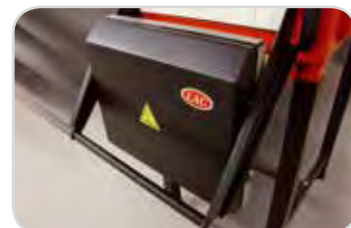
Ručně otevírané dveře pece směrem dolů
