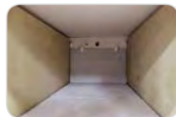
Komora pece s termočlánekem a větracím komínkem
