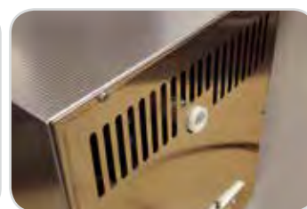
Odtažový komínek pro odtaž zplodin z komory pece
