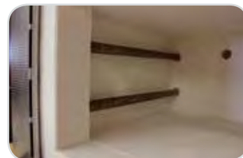
Topná tělesa v trubkách z křemenného skla
