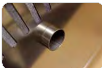
Větrací komínek pro odvětrání pracovního prostoru pece
