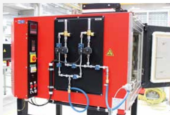
Automatyczne oprowadzenie atmosfery ochronnej
